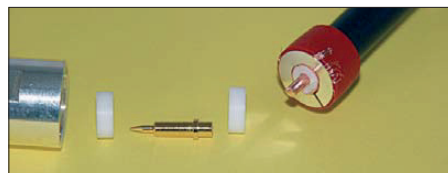
Bild 7: H2000 mit gekürztem Innenleiter und eingeschobenem Schaftkegel
