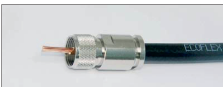
Bild 5: Der Innenleiter muss aus der Hülse hervorragen.
