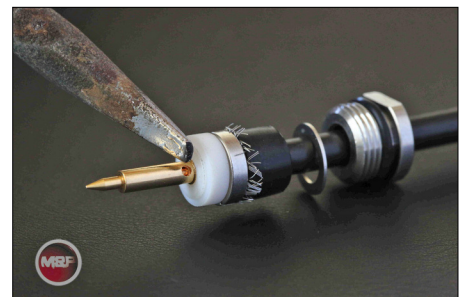
Bild N6: Einen PTFE-Ring aufschieben, Steckerstift aufschieben, durch das Loch Lötzinn hineinlaufen lassen.
