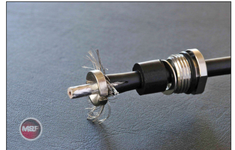
Bild N3: Die Massehülse nun zwischen Außengeflecht und Aluminiumfolie drücken, dabei evtl. mit Steck- oder Ringschlüssel, Röhrchen o. Ä. von vorn nachhelfen.
