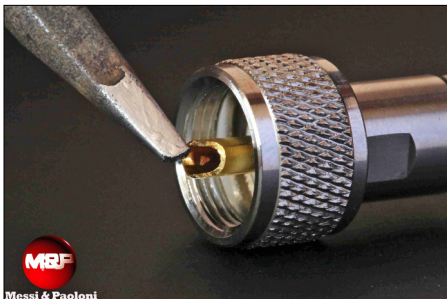
Bild P7: Verschlusschraube von Hand anziehen, mit Maulschlüsseln 11 mm und 12 mm festziehen, dabei etwa 1 mm Spalt lassen. Innenleiter bündig abschneiden und mit wenig Lötinn anlöten. Werkfotos
