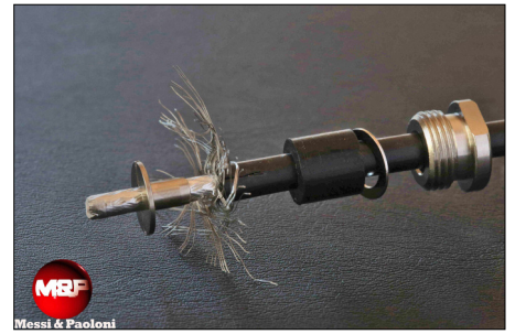
Bild P3: Die Massehülse nun über die Aluminiumfolie schieben. Ggf. Hülse mit Messer o. Ä. etwas aufweiten.
