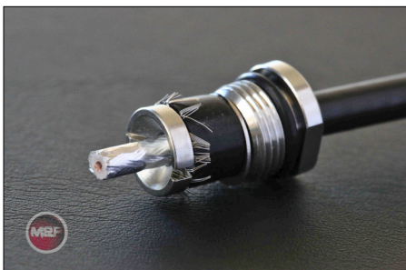
Bild N4: Gummidichtung, Andruckring und Verschlusschraube nach vorn bringen, bis die Gummidichtung die Hülse berührt. Geflecht ringsherum abschneiden, kurze „Stopeln“ stören nicht.
