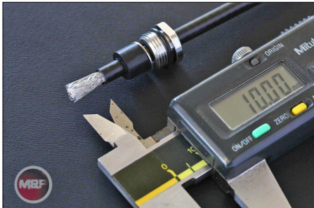
Bild N1: Verschlusschraube, Andruckring und Gummidichtung über das Kabel schieben, PVC-Mantel vorsichtig auf 10 mm abisolieren (stumpfes Messer!)
