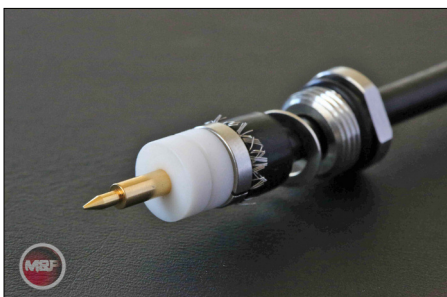
Bild N7: Den zweiten PTFE-Ring über den Steckerstift schieben, bis es nicht mehr weitergeht; vorher evtl. Zinn- oder Kolofoniumreste beseitigen.
