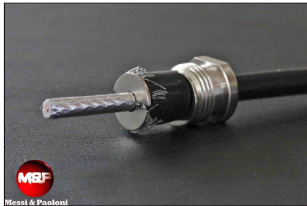
Bild P5: Geflecht nach hinten umkrepeln und ringsherum abschneiden, kurze „Stoppen“ stören nicht.
