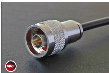
Bild N8: Verschlusschraube von Hand anziehen, mit Maulschlüsseln 11 mm und 12 mm festziehen, dabei etwa 1 mm Spalt lassen.
