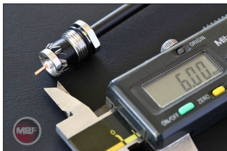
Bild N5: Innenleiter abisolieren, ein schmaler Rand darf stehenbleiben, Einhaltung der Länge 6 mm prüfen, ggf. mit scharfem Seitenschneider kürzen.
