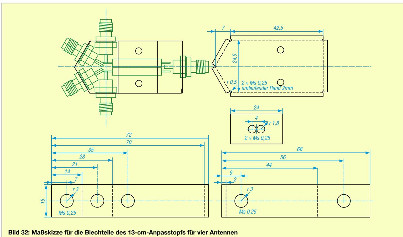
Bild 32: Masskizze fur die Blechteile des 13-cm-Anpasstopfs fur vier Antennen
