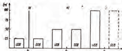
Bild 1: a) Normales AM-Signal, 2 Seitenbänder mit Träger; b) Zweiseitenbandsignal, 2 Seitenbänder ohne Träger; c) Einseitenbandsignal ohne Träger
