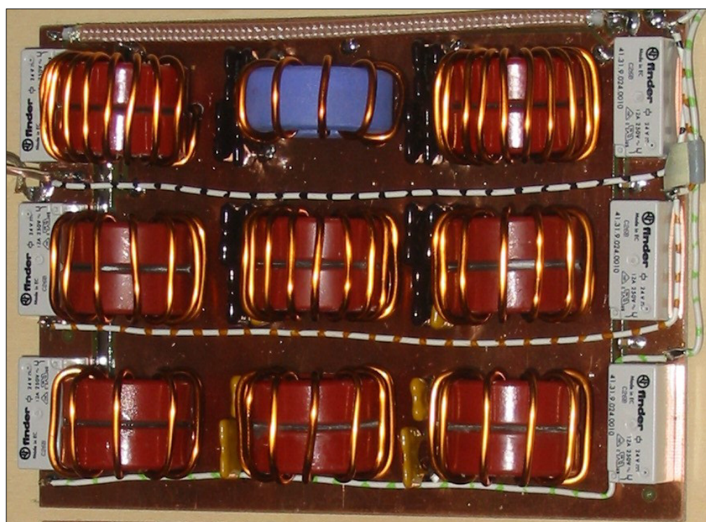
Bild 33: Bestückungsplan der Ausgangsfilterplatine, M 2:1
