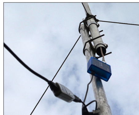
Bild 4: Der miniVNA Tiny lässt sich direkt am Antennenfußpunkt anschließen und mittels eines USB-Verlängerungskabels (Extender) und LAN-Kabel mit dem PC verbinden.
