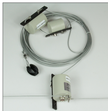
Bild 13: Ansicht der 40-m-Ausführung, Radials hier demontiert; die Verlängerungsspule für 40 m ist bei dieser Ausführung in das Einspeisegerätegehäuse integriert.
