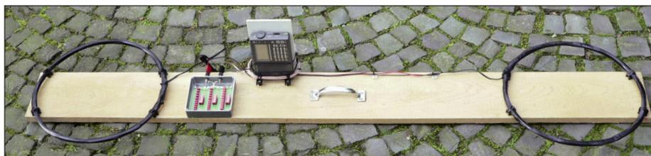
**Bild 23:** Bei der Suche großer, tief liegender Objekte ist ein weiter Spulenabstand wie bei diesem Versuchsaufbau von Vorteil.
