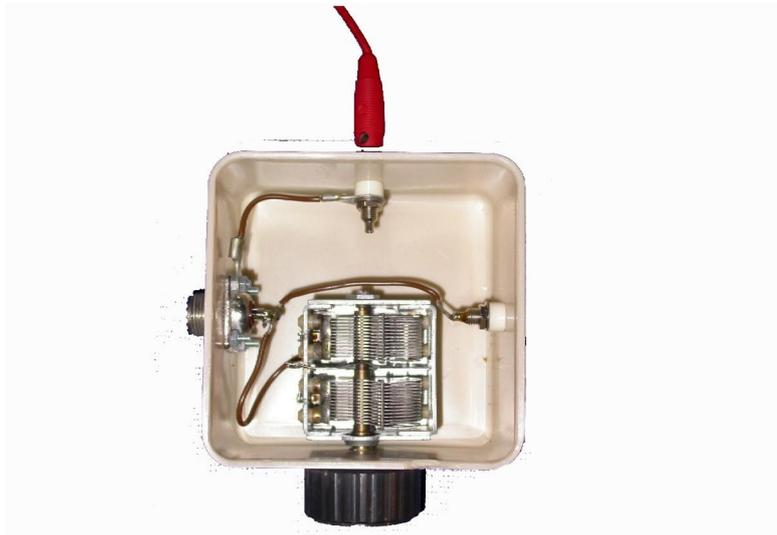
Bild 4: Abstimmbox mit 500-pF-Drehkondensator
