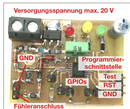
Bild E4: Bestückte Spannungsüberwachungsplatine in der aktuellen Version
