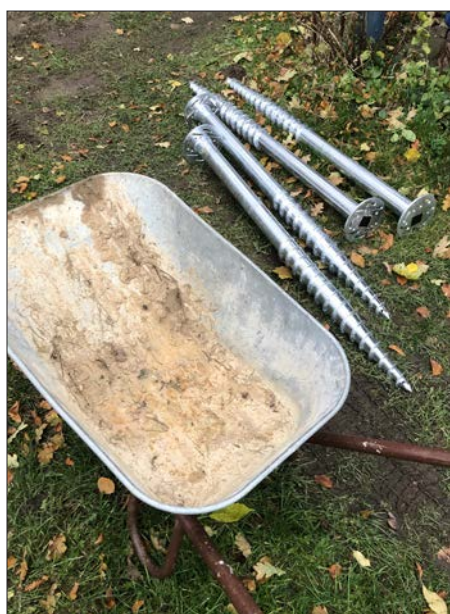
Verwendete Schraubfundamente im Größenvergleich mit einer Schubkarre
