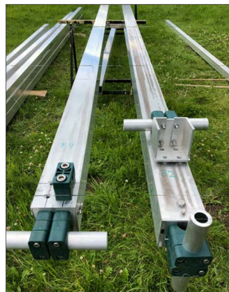
Zwei Mastfüße mit Kippgelenken; auf dem rechten Mast liegt lose ein aus Winkeln gefertigter Mastschuh und mit einem daran befestigten Rohr als Kippgelenk.
