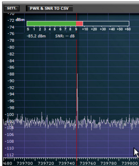
Bild E1: Darstellung des Messsignals ( 10489,750 MHz) mit -140 dBm, vom Konverter heruntergemischt in die ZF-Lage 739,75 MHz ...
