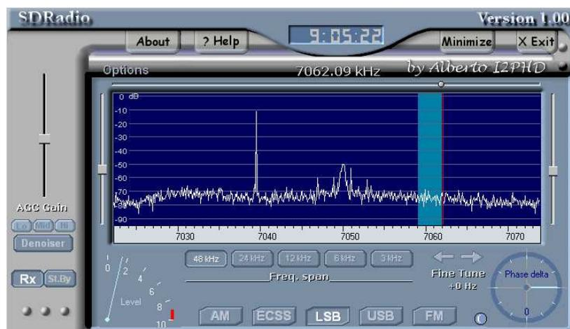
Bild 6: Das NF-Spektrum mit manueller Pegel- und Phasen-Korrektur der IQ-Signale.
