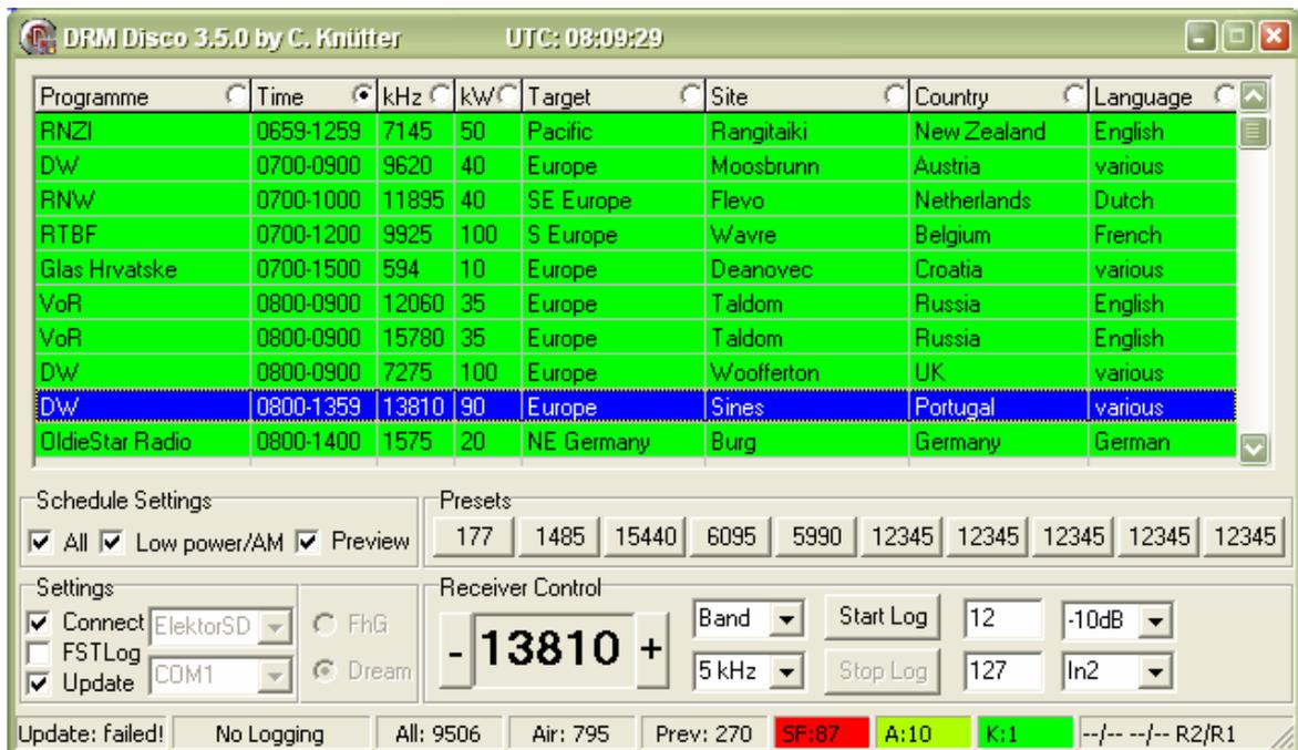
Bild 11: „DRM-Disco“ arbeitet mit „Dream“ zusammen und ermöglicht eine schnelle Empfängerabstimmung.
